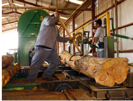
Foto serie 2. Corte de la troza en la sierra cinta en diferentes dimensiones.
