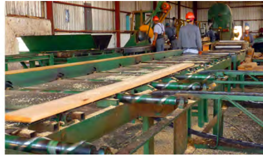
Foto serie 3. Canteadora para dimensionar tablas y tablonés.
