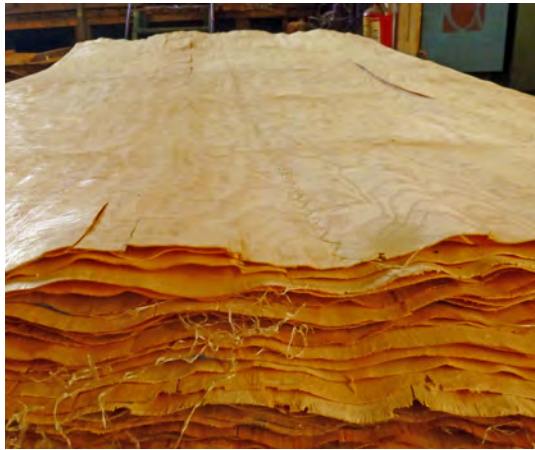
Foto serie 11. Ensamble de chapas. Forestal Alfa, división triplay. Durango, septiembre 2015. Foto: Alejandra Vega B.
