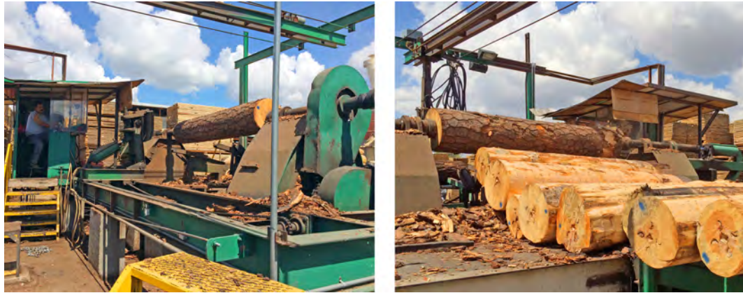
Foto serie 4. Descortezado de la troza. Aserradero Forestal Alfa. Durango, septiembre 2015. Foto: Alejandra Vega B.
