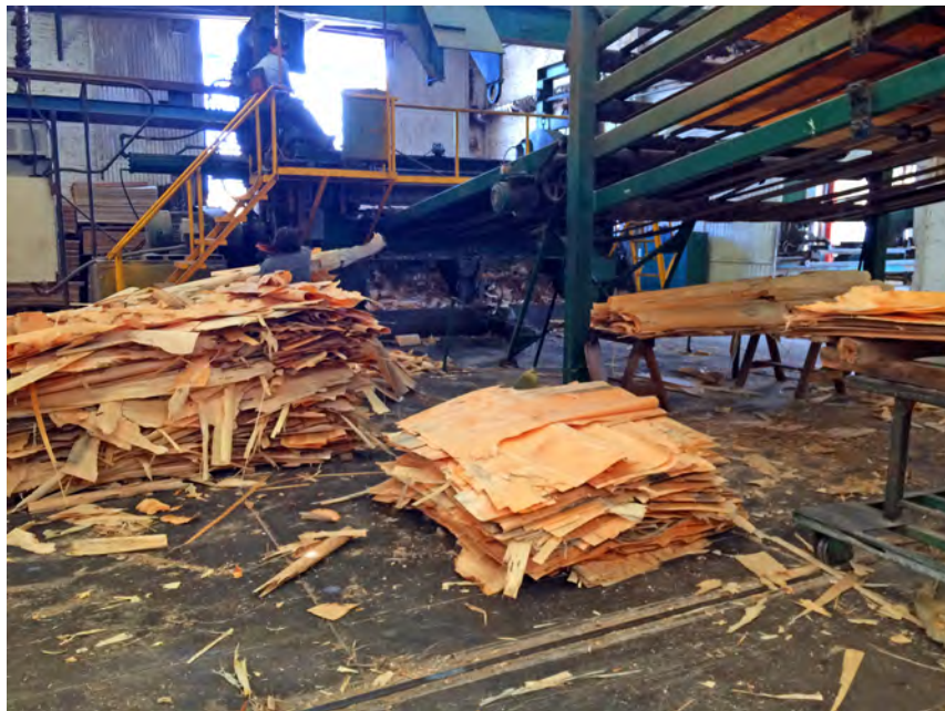
Foto 7. Chapa en pedazos para ensamblarse y armar tableros. Aserradero Forestal Alfa. Durango, septiembre 2015. Foto: Alejandra Vega B.
