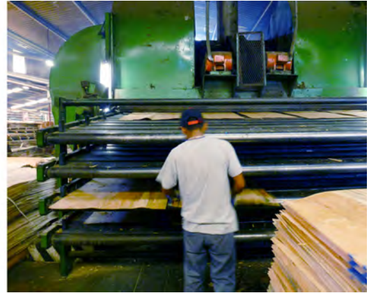
Foto serie 8. Chapa previamente tratada con agua y aceite ingresando a la secadora Moore.
