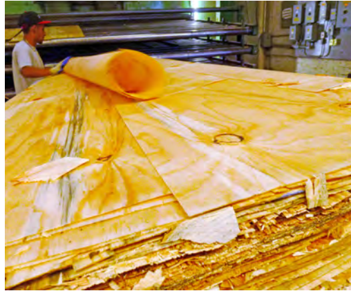
Foto serie 8. Chapa previamente tratada con agua y aceite ingresando a la secadora Moore.
