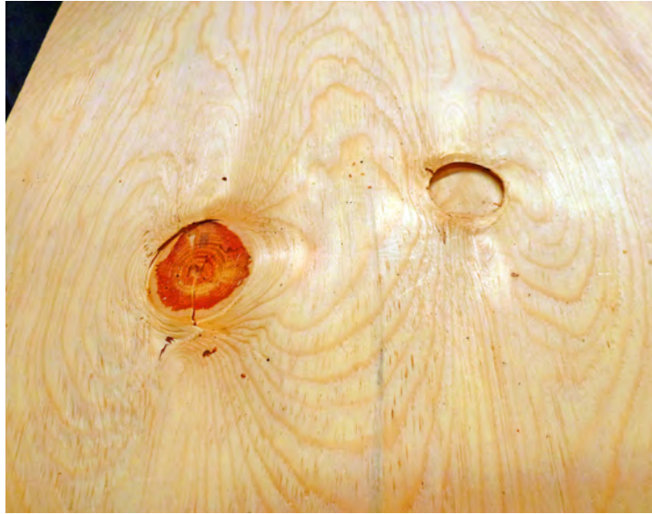
Foto 10. Chapa suajada en los nudos lista para ser parchada. Forestal Alfa, división triplay. Durango, septiembre 2015. Foto: Alejandra Vega B.
