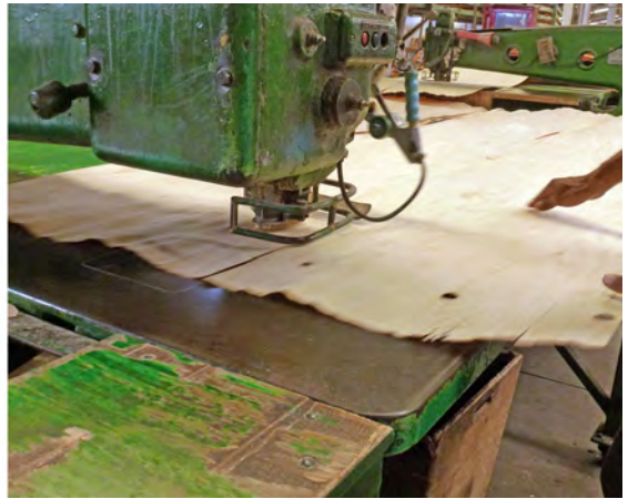
Foto serie 11. Ensamble de chapas. Forestal Alfa, división triplay. Durango, septiembre 2015. Foto: Alejandra Vega B.
