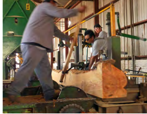
Foto serie 2. Corte de la troza en la sierra cinta en diferentes dimensiones.
