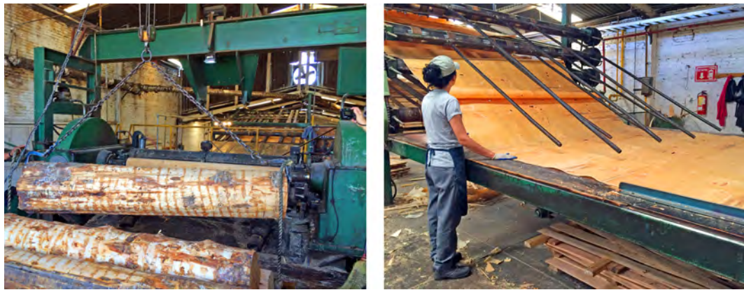
Foto serie 5. Desenrollado de la troza para la obtención de chapa de madera. Aserradero Forestal Alfa. Durango, septiembre 2015. Foto: Alejandra Vega B.
