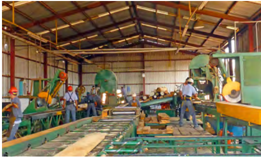
Foto serie 3. Canteadora para dimensionar tablas y tablonés.
