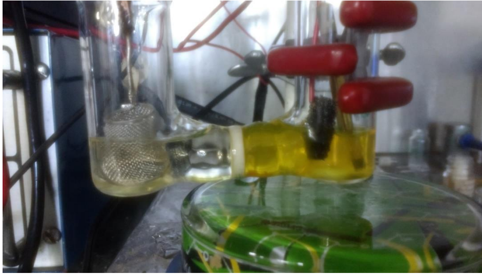
Imagen 1. Fotografía de celda tipo H con disposición de electrodos para electrólisis potencioestática.
