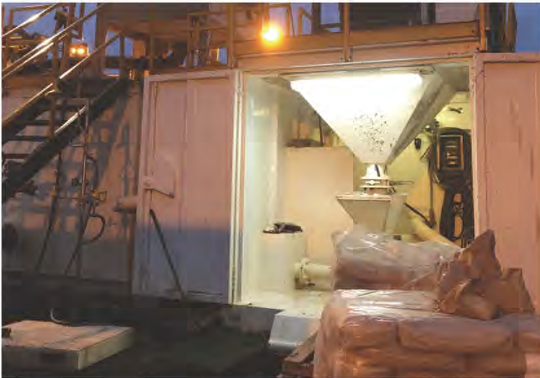
Figura 2. 5 Barita utilizada como aditivo para los lodos de perforación en el campo geotérmico Theistareykir, Islandia. Fuente: Archivo de la autora, 2016.
