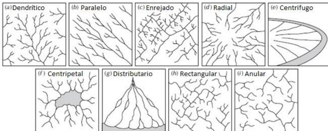
Figura 1.470.- Patrones de drenaje controlados por la estructura o la pendiente (Twidale y Campbell, 1993, adaptado de Twidale 2004, en Huget, 2007).
