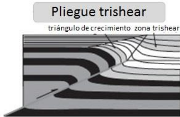
Figura 1.36.- Modelo de pliegue trishear y estratos de crecimiento por encima de una cabalgadura. (Modificado de Wickham, 1995 y Allmendinger, 1998 en Burbank y Anderson, 2012)
