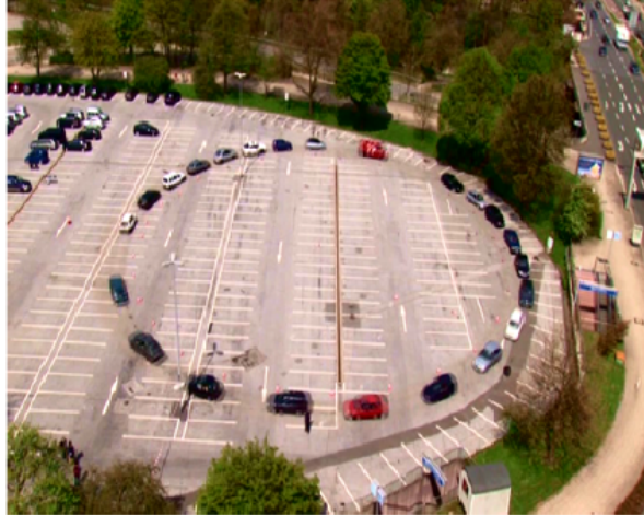
Figura 2.4: Experimento llevado a cabo para mostrar la formación de congestionamientos espontáneos.(Sugiyama et al., 2008)
