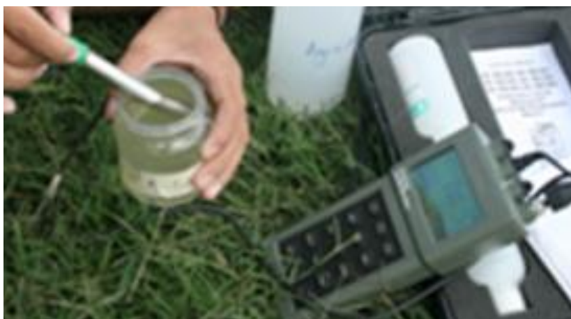
Figura 12. Toma de muestras con multiparámetro marca Hanna HI 95928.
