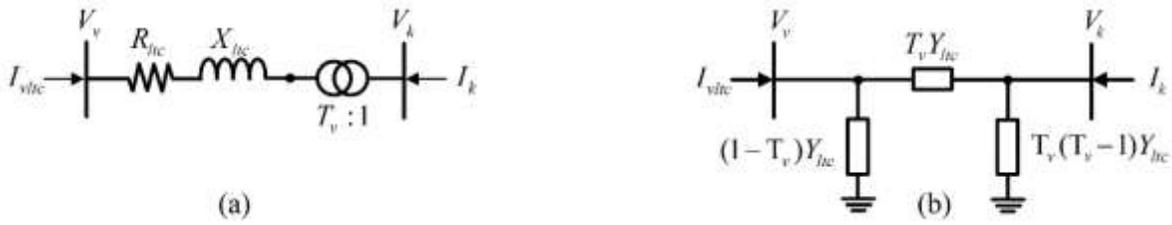
**Figura 3.5** Representación simplificada del modelo del transformador OLTC para flujos de potencia;
