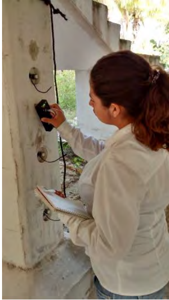
Figura 51. Medición de resistencia. Fotografía Ing. Jorge Mena
