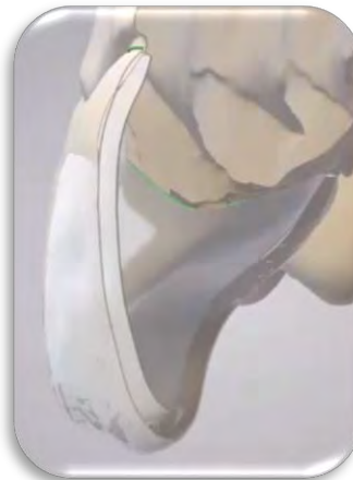
Figura 22 La opción de cáscara de huevo crea un grosor de material regular. 35
