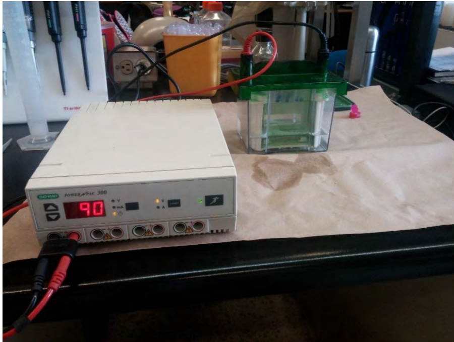
Figura 11. Electroforesis con geles de poliacrilamida, para separar las proteínas de acuerdo a su movilidad electroforética.
