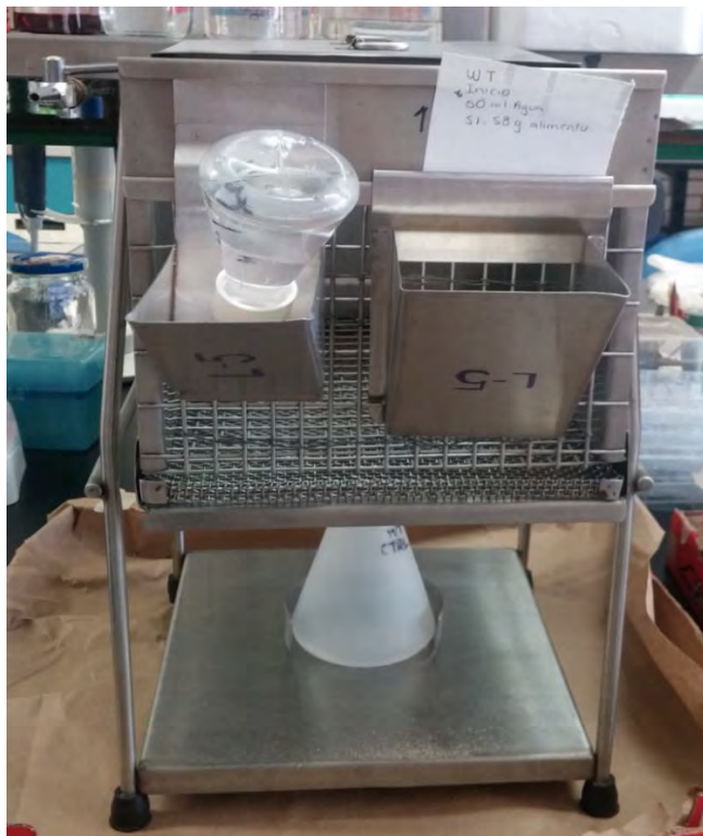
Figura 7. Caja metabólica en la que se determina ingesta de agua y alimento, así como volumen de orina producida por ratones sanos y diabéticos en un lapso de 24 h.
