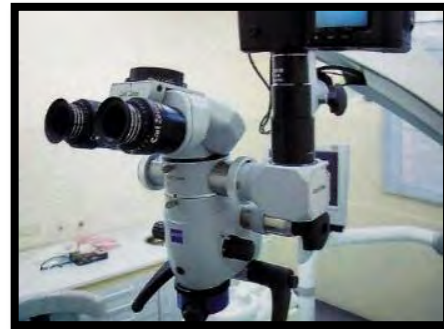
Figura 14. Configuración típica de un MO, con accesorios para documentación.
