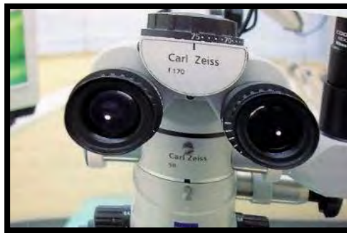
Figura 17. Discos para ajustar la distancia interpupilar de los binoculares.
