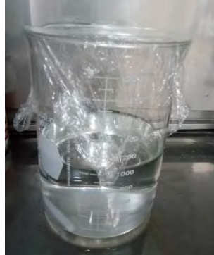
Fig. 25 Disolución de ácido clorhídrico al 10%.
