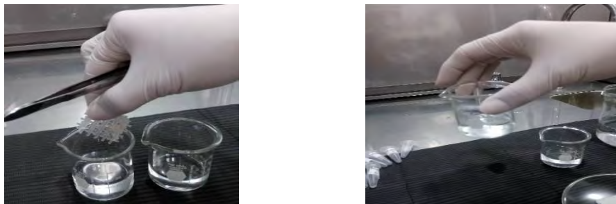
Fig. 28 Lavado de la muestra a) en el primer vaso de precipitado b) en el segundo vaso de precipitado.
