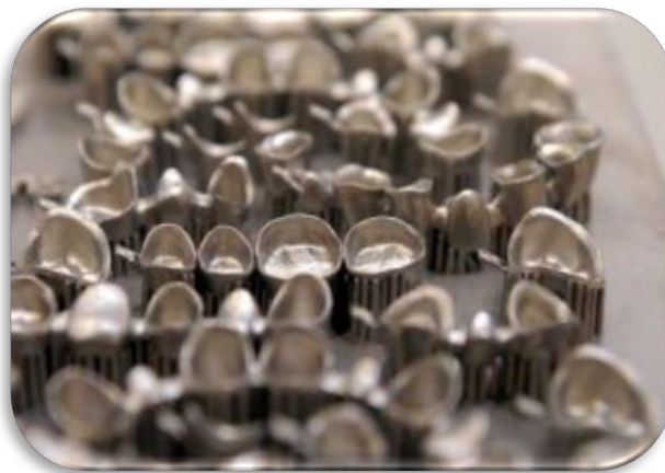
Figura 4 Aparatos dentales realizados utilizando el sinterizado selectivo por láser (SLS).
