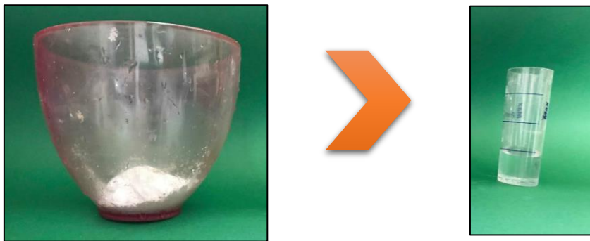
Figura 42 Se coloca una medida de polvo por una de agua con los recipientes medidores. FD
