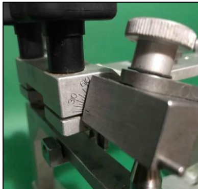
Figura 31 Calibración en grados de la inclinación del techo de la cavidad. FD
