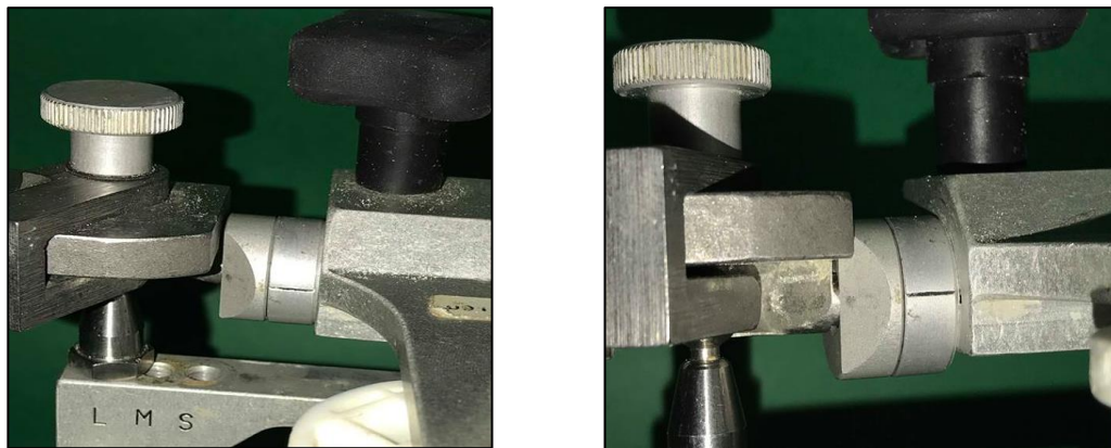
Figura 33 Espaciadores condilares en donde el espaciador biselado siempre irá hacia la caja condilar. FD
