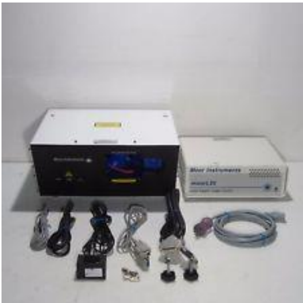
Figura 42. Láser Doppler de Moor con todos sus aditamentos para la valoración del flujo sanguíneo. ( https://www.ebay.com/itm/MOOR-INSTRUMENTS-MOORLDI-LASER-DOPPLER-IMAGER-CONTROLLER-MOORLDI2-2-LDI-/162080812834 )
