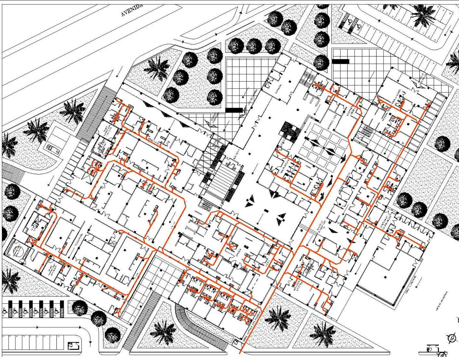
PLANTA BAJA – INSTALACIÓN SANITARIA
