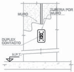
COLOCACION DE CONTACTOS
