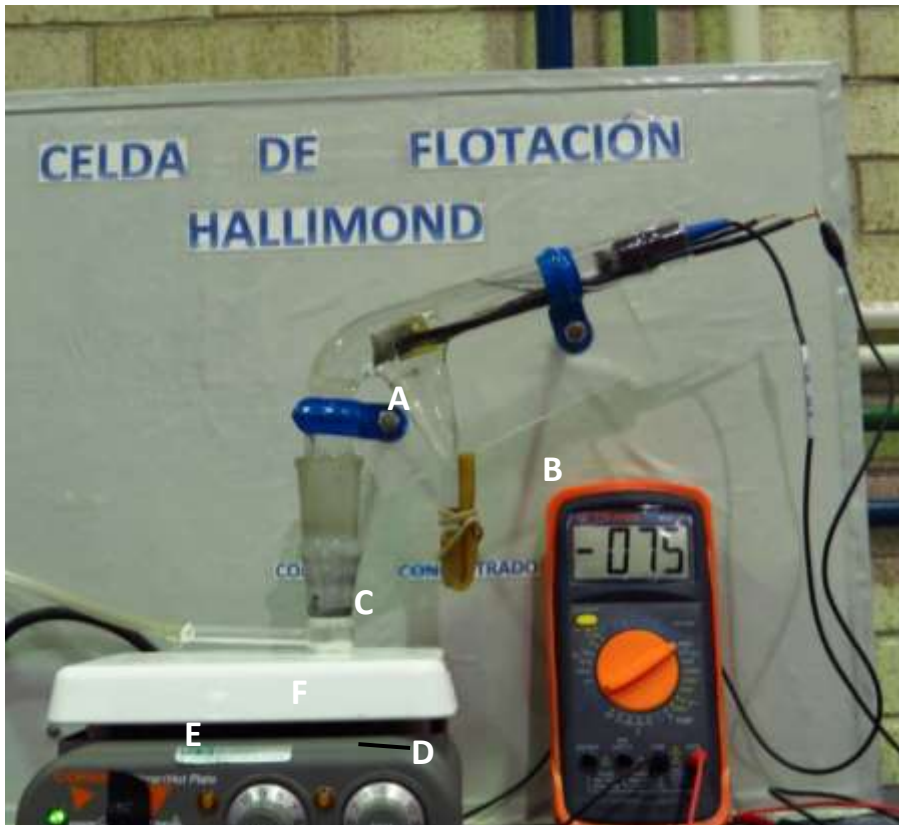
Figura 20 Montaje de celda Hallimond empleada para las pruebas de flotación de pirita y galena.
