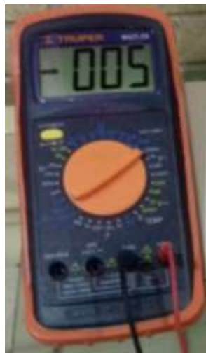
Figura 22 Multímetro empleado para la medición de potencial en los procesos de flotación de celda Hallimond y Denver.
