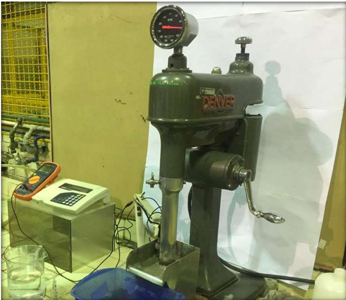
Figura 30 Celda de flotación Denver con los aditamentos necesarios para realizar las mediciones de potencial y pH
