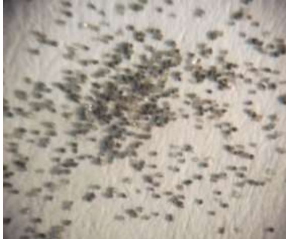
Figura 28 Fracciones de mineral completamente liberado a un tamaño de 106 \mu m.
