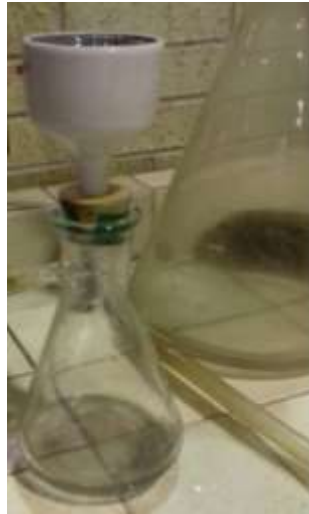
Figura 23 Matraz Kitasato con embudo Büchner empleado para filtrar el mineral recuperado.
