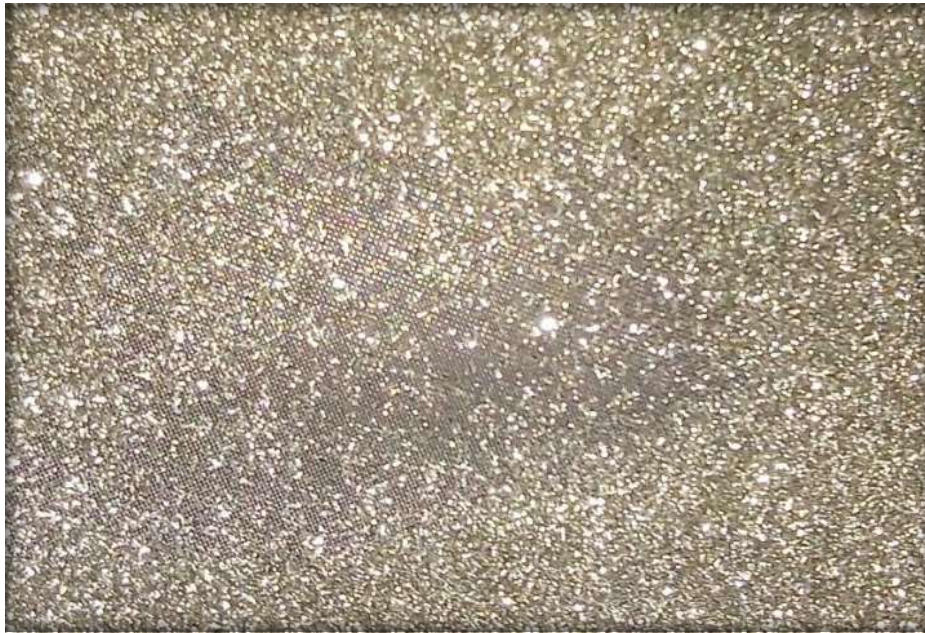
Figura 15 Mineral de Pirita retenido en malla 200
