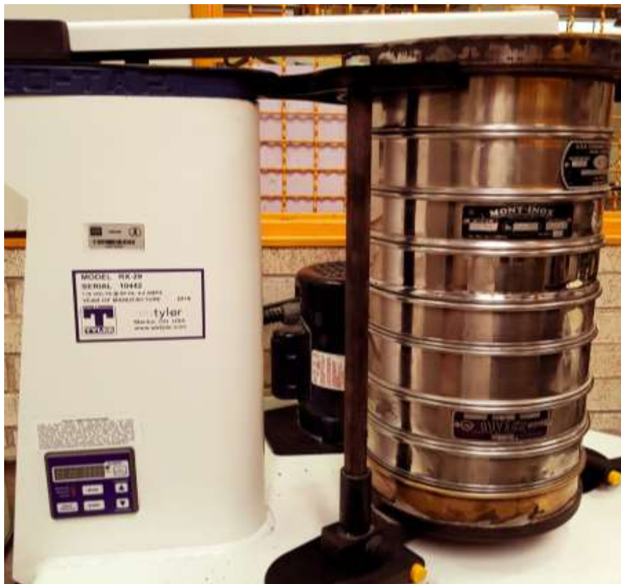
Figura 27 Ro Tap empleado para la clasificación del mineral
