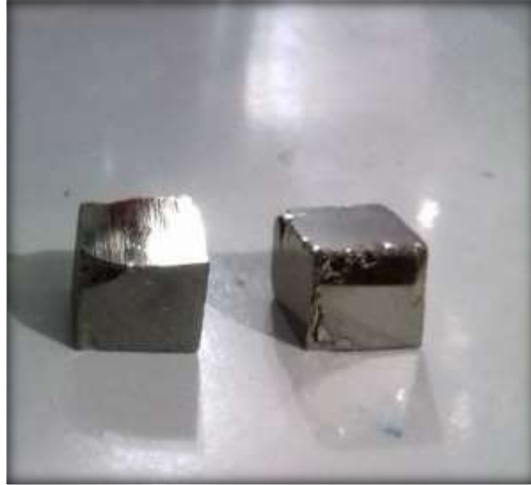
Figura 10 Porciones de mineral con superficie de 1 cm 2 para poder formar los electrodos de mineral de pirita y galena.
