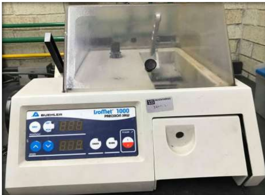
Figura 13 Cortadora de precisión de disco de diamante marca BUEHLER modelo IsoMet 1000
