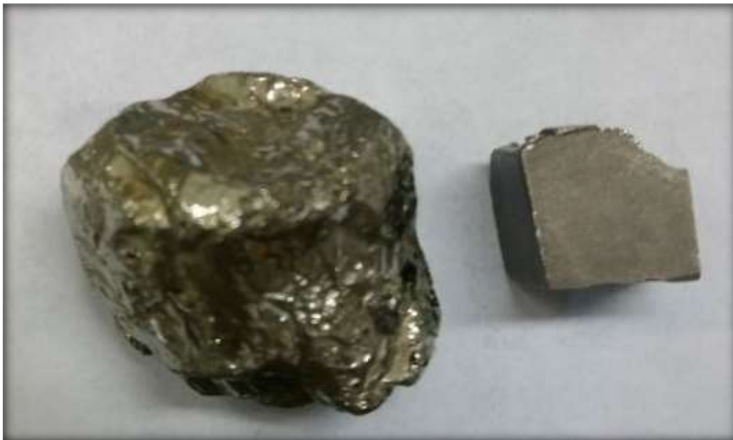
Figura 9 Muestra de mano de mineral de pirita antes y después de su tratamiento. .
