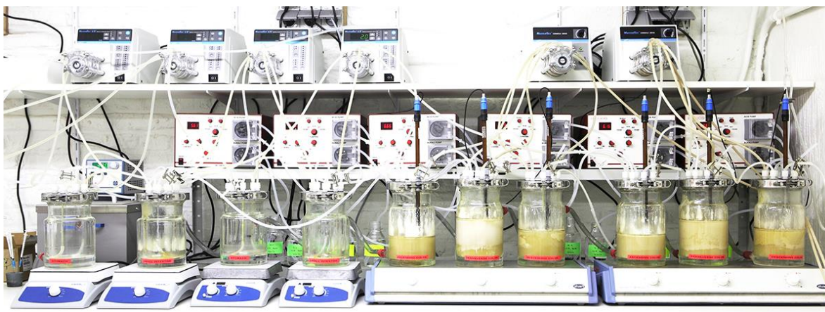
Figura 55 Simulador del ecosistema microbiano intestinal (SHIME) (Robinson & Reeves, 2013)
