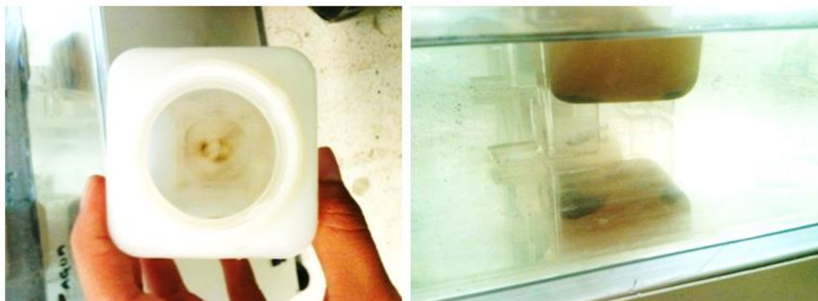
Figura 17 A la derecha, los recipientes flotando en la tina de acrílico; a la izquierda, incrustación del material en el recipiente ocasionada por el uso del agitador magnético.
