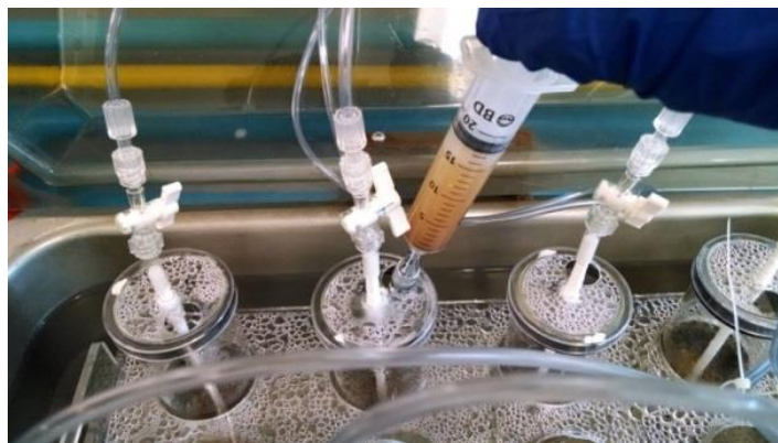
Figura 39 Toma de muestra en el RSGB
