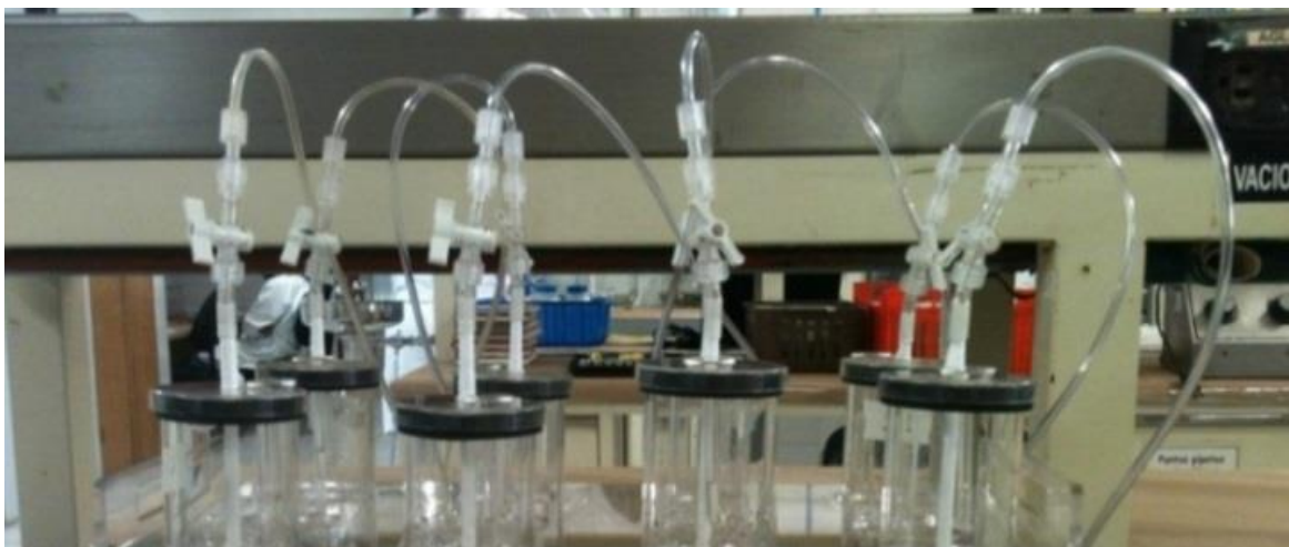
Figura 36 Control de flujo de gas en los reactores.
