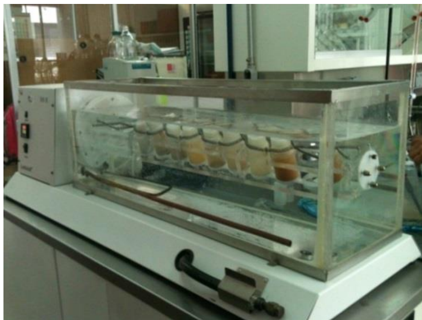
Figura 18 Equipo NOM 147 (LGA-IG) basado en el método SBET/RBALP/SBRC.
