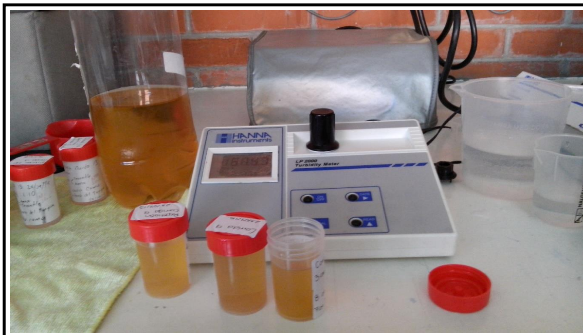
Figura 2.5 Determinación de turbidez del nejayote y de nejayote diluido
