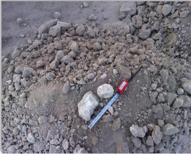
**Fotografía 9.** Se muestra material producto de la excavación del Pozo a Cielo Abierto (PCA-04) para la MLV-206, compuesto por Grava Arcillosa con Fragmentos chicos de roca, los cuales, tiene tamaños de hasta 20.00 cm, la muestra fue recuperada a profundidad entre 0.15 – 1.50 metros.
