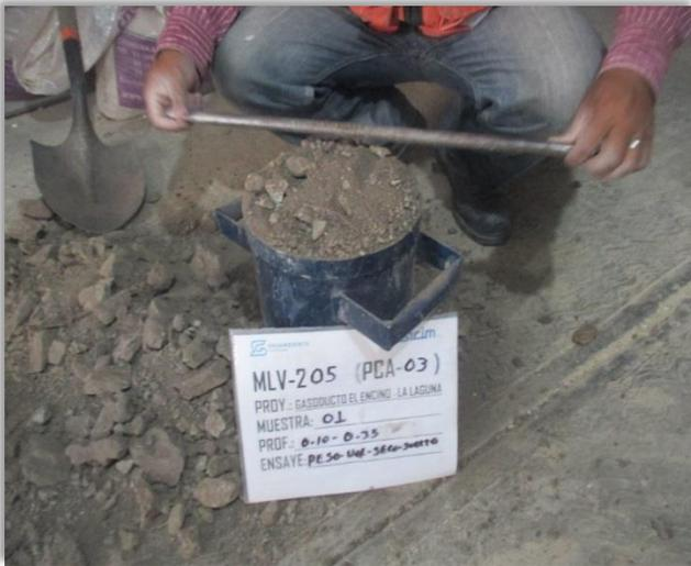
**Fotografía 29.** Se observa el procedimiento mediante el cual se logra la Determinación de los Pesos Volumétricos Seco Suelto y Seco Varillado, de la muestra número uno, del Pozo a Cielo Abierto (PCA-03), para la válvula MLV-205.
