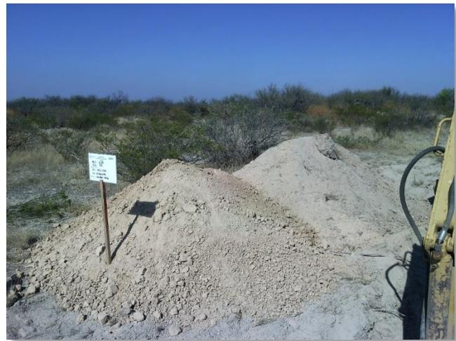
**Fotografía 12.** Material producto de la excavación, alojado al costado del Pozo a Cielo Abierto (PCA-07) para la válvula MLV-208, el cual consiste en arcilla de baja plasticidad con grumos de la misma, fue clasificado en campo y muestreado para su traslado a laboratorio central.
