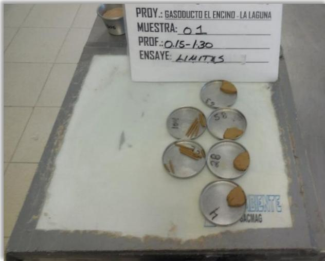
**Fotografía 33.** Se muestra el procedimiento para la Obtención de los límites de Atterberg de la muestra recuperada del (PCA-05) para la Válvula MLV-206, material recuperado entre 0.15 – 1.30 metros de profundidad.
