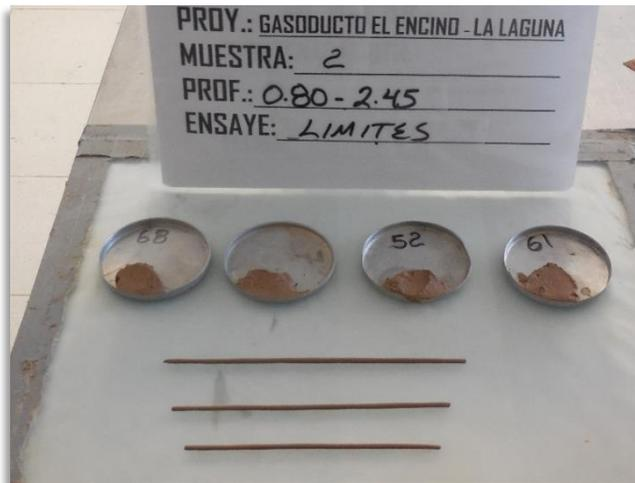
**Fotografía 23.** Se aprecia el proceso para determinar el límite plástico a través del moldeado de tres cilindros de diámetro aproximado de 2.5 – 3.00 mm, se dice que se alcanza el límite plástico una vez que alcanzando estos diámetros el material presenta algunas fisuras. Se observan los testigos para medición de humedades obtenidos durante el ensaye de límite líquido.
