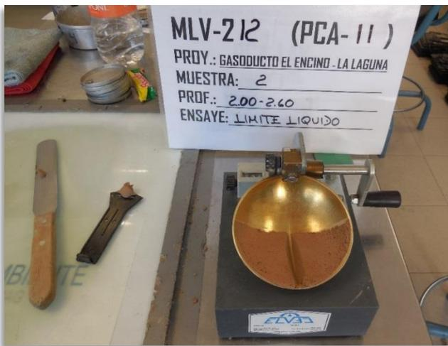
**Fotografía 39.** Copa de Casagrande empleada para la determinación del límite líquido de la muestra número 2, del Pozo a Cielo Abierto (PCA-11) para la válvula MLV-212, recuperada entre 2.00-2.60 metros de profundidad.
