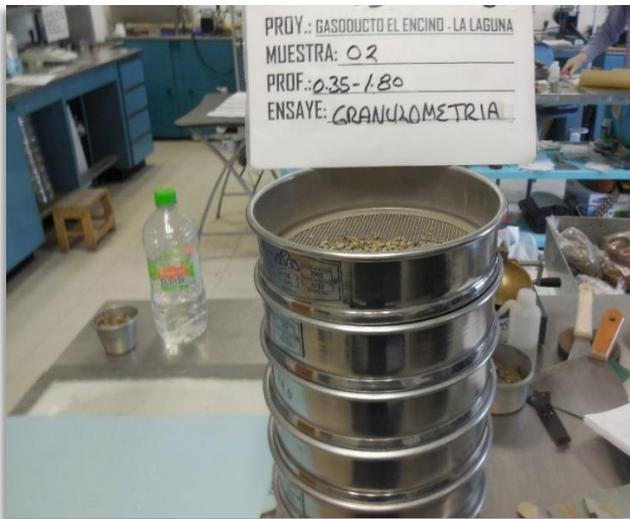
**Fotografía 27.** Se observa el procedimiento mediante el cual se determina la granulometría del material recuperado, el cual pasa por el cribado mediante mallas, para la muestra número 2 del Pozo a Cielo Abierto (PCA-203) para la válvula MLV-205.
