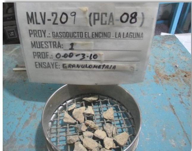
**Fotografía 38.** Se observa Gravas retenidas mediante granulometría por medio de mallas de la muestra obtenida del Pozo a Cielo Abierto (PCA-08) para la válvula MLV-209.
