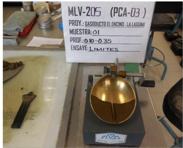
**Fotografía 28.** Obtención del límite líquido, mediante el empleo de la copa casagrande, de la muestra número uno del Pozo a Cielo Abierto (PCA-03) recuperada entre 0.10 a 0.35 metros de profundidad para la válvula MLV-205.
