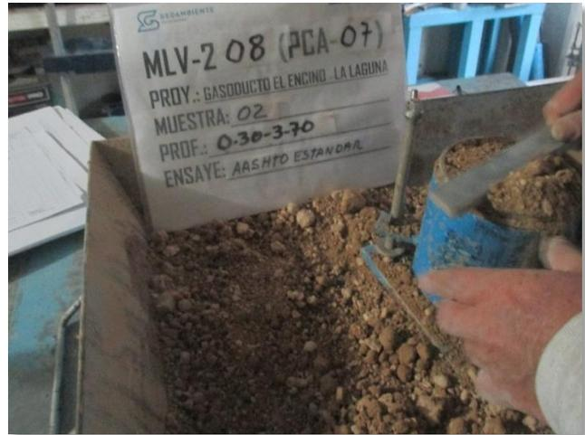
**Fotografía 36.** Determinación del Peso Volumétrico Seco Máximo, mediante la prueba AASHTO ESTANDAR, de la muestra número dos (2), recuperada a profundidad entre 0.30 – 3.70 mediante el Pozo a Cielo Abierto (PCA-07) para la válvula MLV-208.
