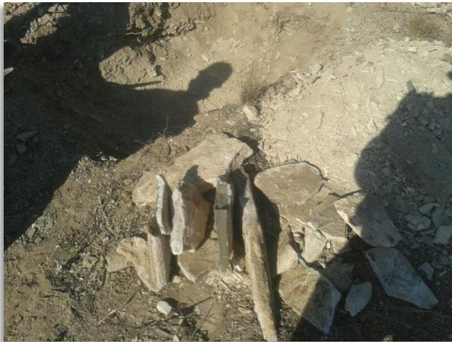
**Fotografía 3.** Material producto de la excavación del Pozo a Cielo Abierto (PCA-02) para la válvula MLV-204, el cual es depositado al pie del mismo para su eventual muestreo. El material de sitio, se clasifica como Grava Arcillosa con Fragmentos de medianos a chicos de Roca de forma subredondeada y lajeada de textura rugosa y poca arena gruesa.
