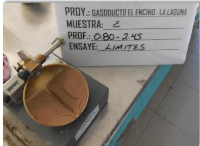
**Fotografía 22.** Copa de Casagrande empleada para la determinación del límite líquido de la muestra número dos, recuperada entre 0.80 – 2.45 metros de profundidad del Pozo a Cielo Abierto (PCA-01) para la válvula MLV-203.
