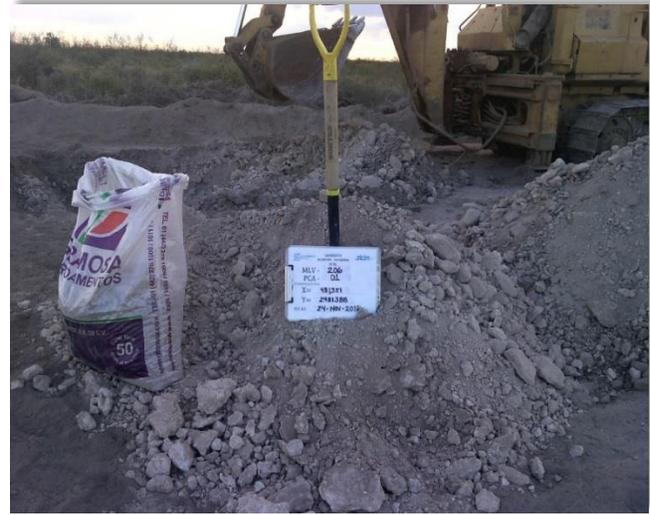
**Fotografía 10.** Material producto de la excavación, en el cual se puede apreciar los fragmentos chicos de roca con poco carbonato de calcio, la presencia de gravas y el material arcilloso del Pozo a Cielo Abierto (PCA-04) para la MLV-206 fue muestreado, etiquetado y marcado para su traslado a laboratorio.
