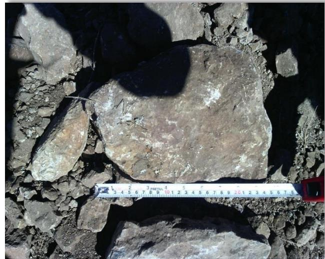
**Fotografía 6.** Se visualiza Fragmentos medianos de roca (lutita) resultado del proceso de excavación del Pozo a Cielo Abierto (PCA-03) para la MLV-205. Se observa el tamaño de los fragmentos de hasta 8" de Diámetro.
