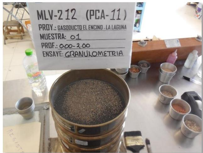
**Fotografía 40.** Se muestra el proceso de obtención de granulometría del material recuperado del Pozo a Cielo Abierto (PCA-11) para la Válvula MLV-212.
