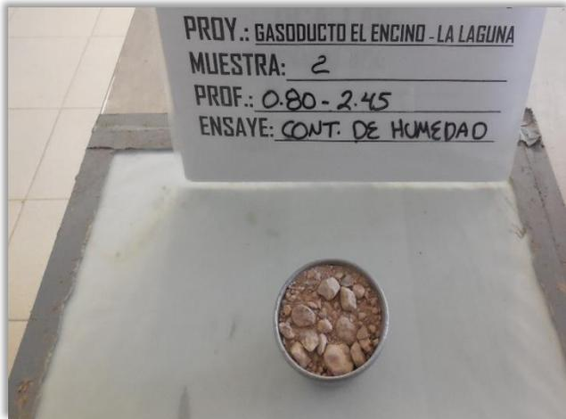
**Fotografía 21.** Se muestra el procedimiento en laboratorio, para determinar el contenido de humedad de la muestra 2, recuperada del Pozo a Cielo Abierto (PCA-01) para la válvula MLV-203, con profundidad entre 0.80 y 2.45 metros.
