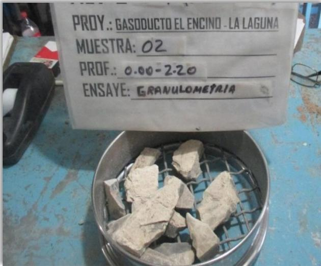
**Fotografía 25.** Se observa Fragmentos chicos de roca obtenidos de la prueba de granulometría por medio de mallas, realizada a la muestra número 1 del Pozo a Cielo abierto (PCA-02) para la válvula MLV-204, recuperada a profundidades entre 0.00 – 2.20 metros.
