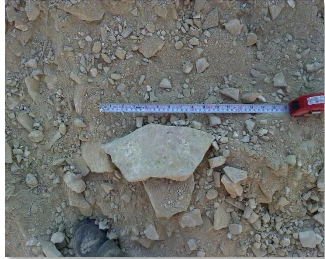
**Fotografía 8.** Se realiza la clasificación visual y al tacto del material producto de la excavación del Pozo a Cielo Abierto (PCA-06) para la válvula MLV-207, el cual consiste en fragmentos medianos y chicos de roca, envueltos en una matriz de gravas y finos de color café claro.
