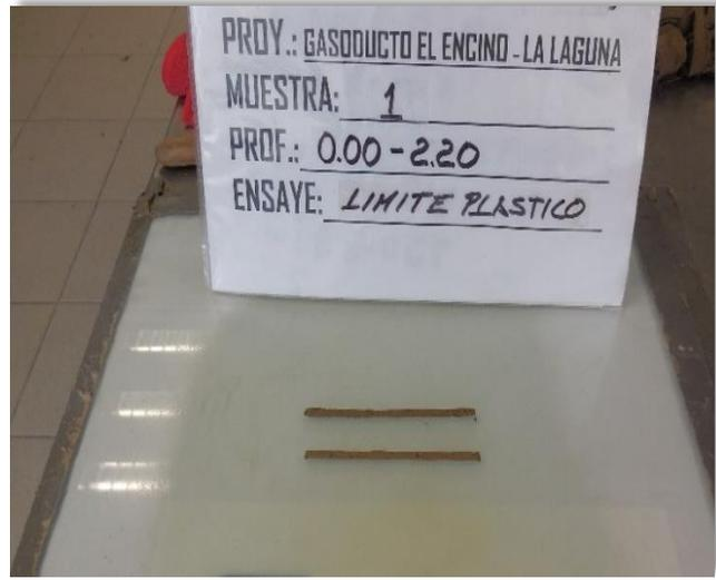
**Fotografía 26.** Obtención del límite plástico a través del moldeado de cilindros de aproximadamente 2.50 – 3.00 mm de diámetro, con material fino, recuperado mediante Pozo a Cielo Abierto (PCA-02) para la válvula MLV-204.
