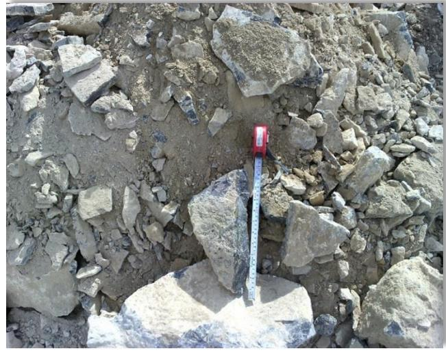
**Fotografía 14.** Se observa el material constituido por Fragmentos de medianos a chicos de Roca de forma lajeada del Pozo a Cielo Abierto (PCA) para la MLV-209. El material fue recuperado a profundidades entre 0.30 – 3.10 metros; es muestreado, etiquetado y marcado para su traslado a laboratorio.
