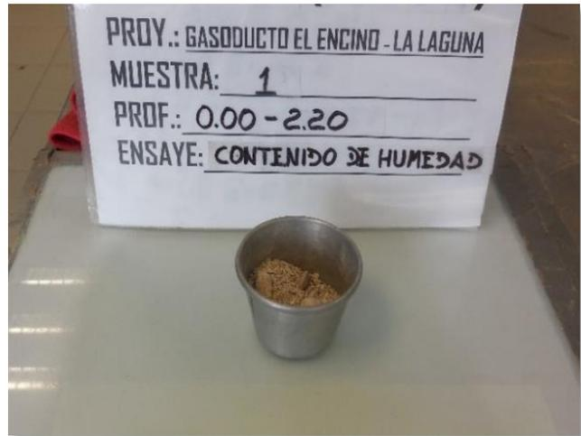
**Fotografía 24.** Muestra para la determinación de contenido de humedad natural de la muestra número 1 del Pozo a Cielo Abierto (PCA-02) para la válvula MLV-204, obtenida a profundidad entre 0.00 – 2.20 metros.
