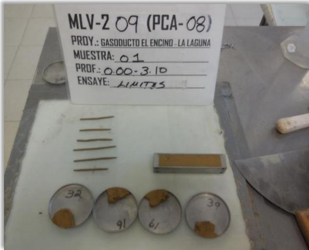
**Fotografía 37.** Proceso para determinar los límites de Atterberg de la muestra recuperada mediante el Pozo a Cielo Abierto (PCA-08) para la válvula MLV-209, de la muestra recuperada a una profundidad entre 0.00 – 3.10 metros.
