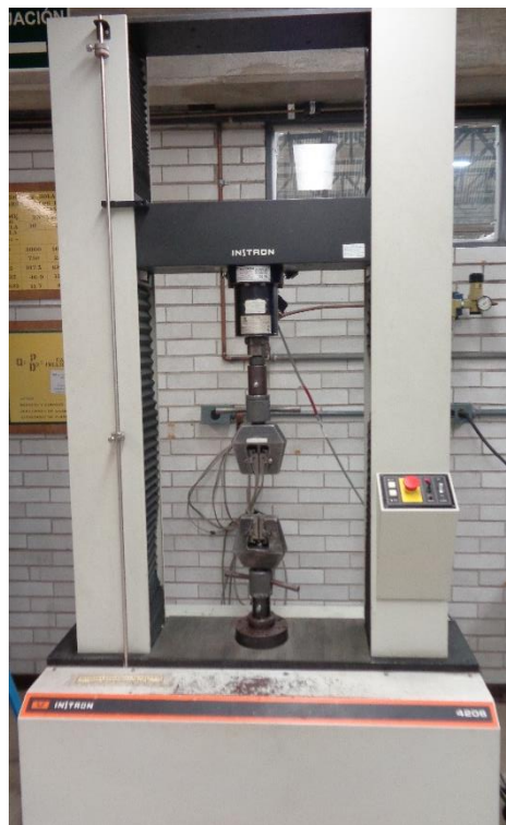
Figura 22. Ensayo de tracción en una máquina universal de pruebas mecánicas marca INSTRON. Prueba realizada en el Departamento de Materiales y Manufactura de la Facultad de Ingeniería, UNAM
