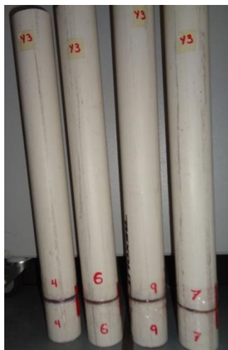
Figura 23. Ensayo de permeabilidad empleando dos tubos de PVC de 4 cm de diámetro
