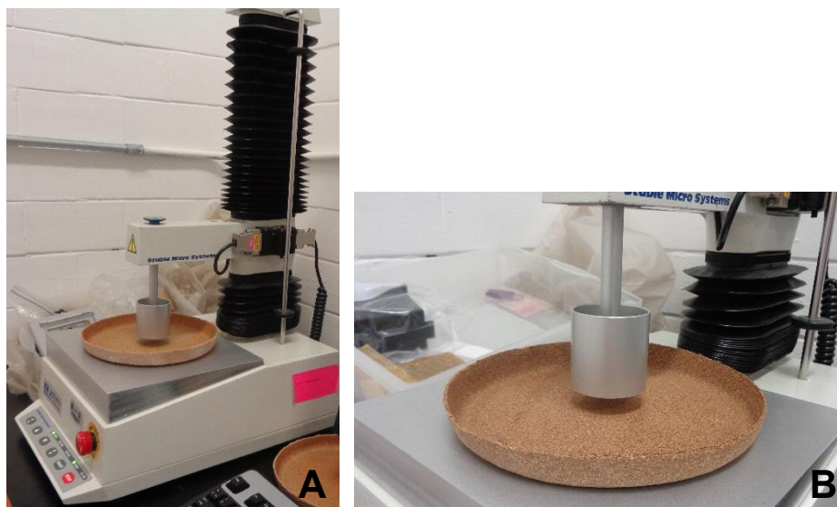
Figuras 21A y 21B. Análisis de perfil de textura de los platos en un TA.XT2 plus (Stable Micro System). Prueba realizada en el Departamento de Alimentos y Biotecnología de la Facultad de Química, UNAM
