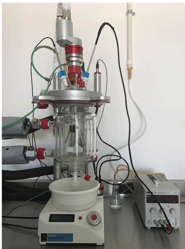
Fig. 44: Reactor Syrris Atlas HD Calorimeter donde se realizaron todas las reacciones de polimerización
