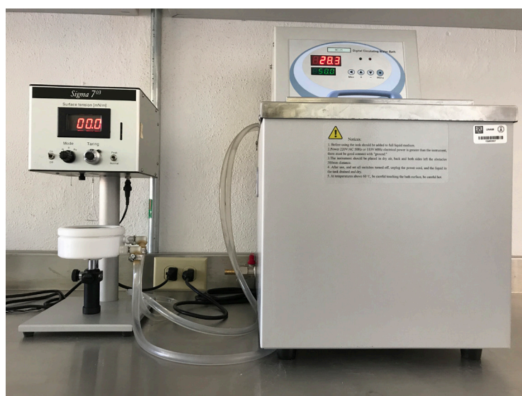
Fig. 43: Tensiómetro Sigma 703 KSV y re-circulador de agua SCIENTZ SC-15, utilizados para las mediciones de tensión interfacial.
