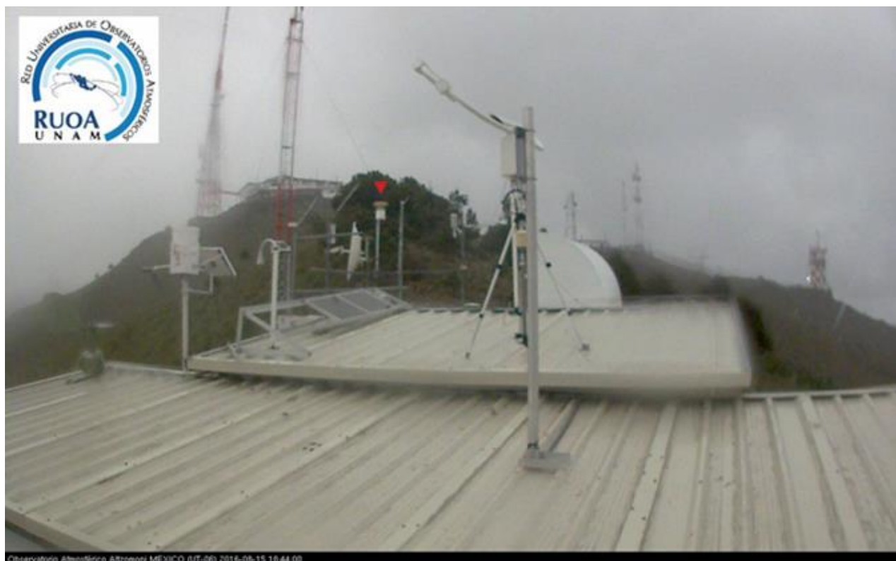
Figura 5.4. Imagen del observatorio atmosférico de la RUOA durante el evento del 15 de agosto de 2016 a las 18:44. En primer plano, al PWS100 y, en el fondo, señalado con un triángulo, el pluviómetro Texas.
