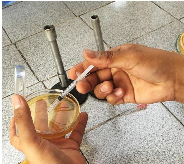
Figura 8. Siembra por técnica de inundación en agar con jeringa estéril.
