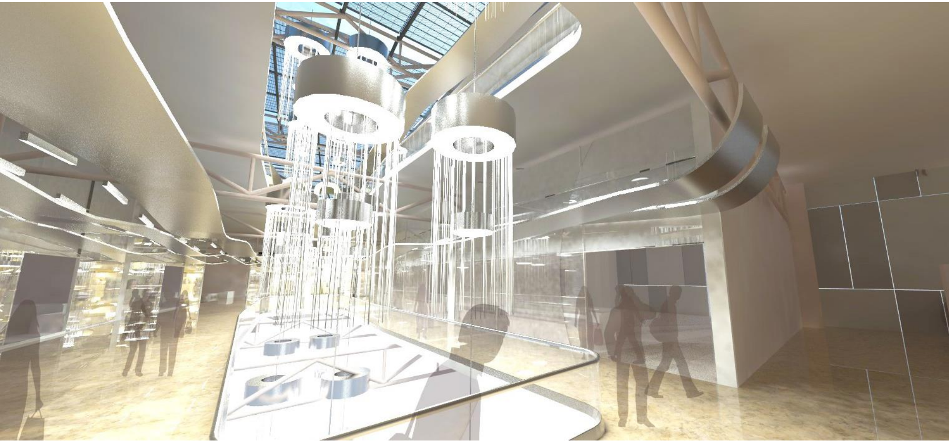
Fig. 54; Vista desde planta alta, desde uno de los cubos de circulations verticales, hacia los pasillos de locales comerciales. Los vanos conectan el espacio a altura múltiple, junto con las lámparas “tipo medusa” fabricadas en taller, las cuales están fabricadas con mechones de fibra óptica, que ayudan con la entrada de luz desde azotea, natural o artificialmente. (2015) Luis Colín.
