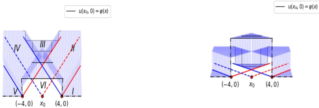
(a) Propagación de la posición inicial  $\varphi$  en las regiones *VI*, *II* y *IV* delimitadas por las rectas  $x \pm \frac{1}{2}t = \pm 4$  cortando una con otra en  $(8, 0)$ .
