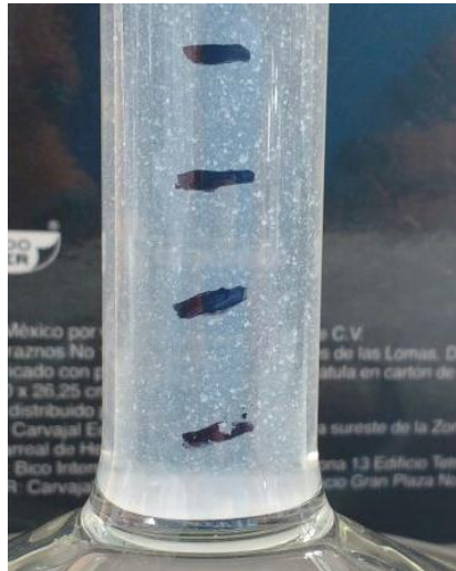
Figura 3.19 Sedimentación de partículas de \text{TiO}_2 depositado sobre tierras diatomeas.
