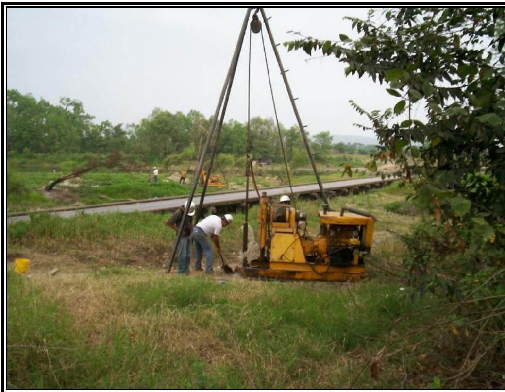
FOTO No. 5 EXPLORACION CON MAQUINA EN SONDEO S-1 Y S-2
