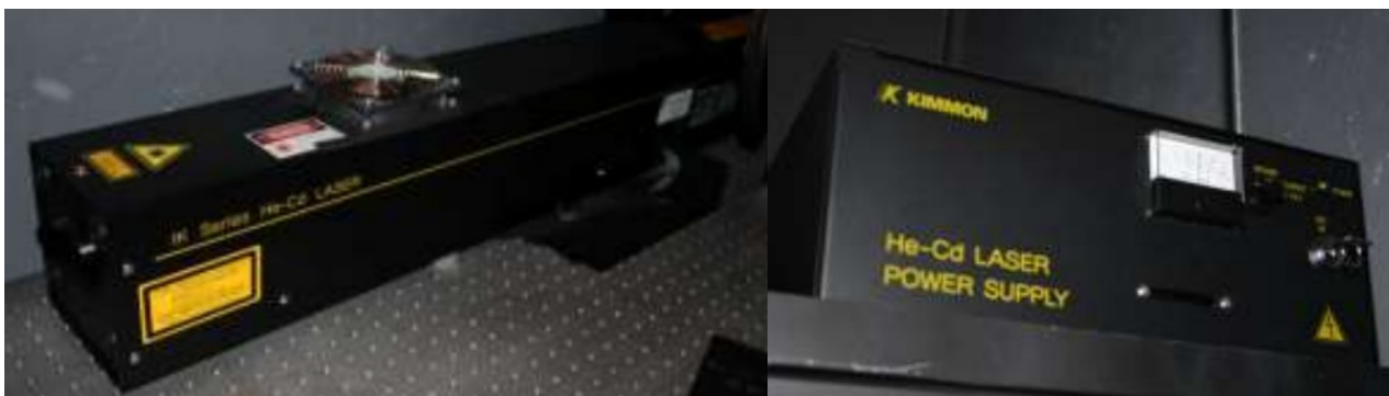
Fig. 4.7. Láser de He-Cd utilizado para la caracterización por fotoluminiscencia.
