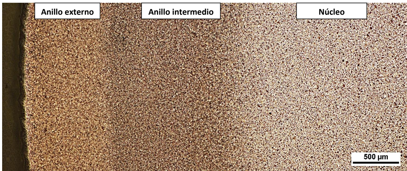
Fig. 7.2.- Zonas microestructurales en muestra estándar de 19.05 mm diámetro. GC-D.
