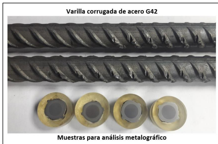
Fig. 6.2.- Preparación de muestras para análisis metalográfico.
