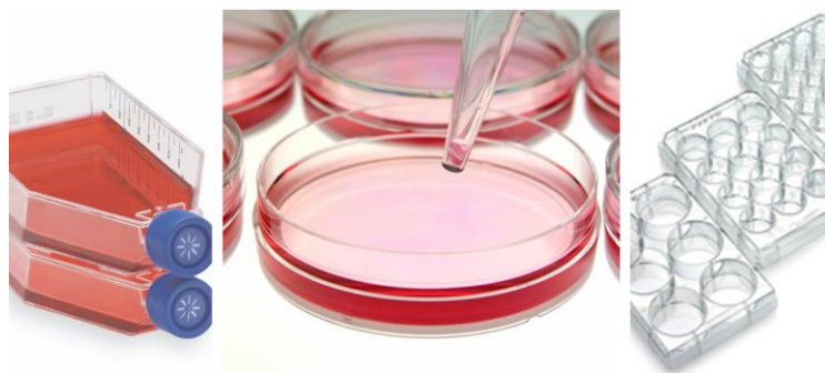
Figura 9. Diversos formatos para cultivo bidimensional en poliestireno
