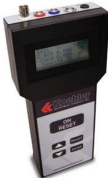
Figura 9.4: Salinometro para medir el contenido de sal en petróleo.
