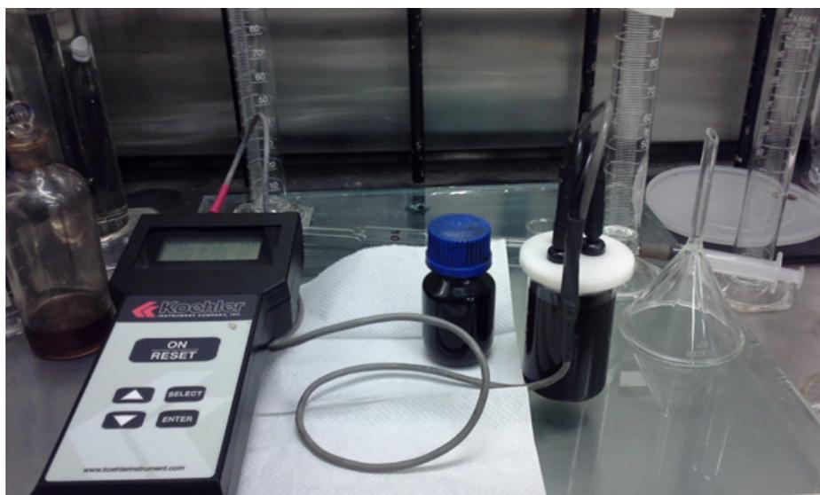
Figura 10.7: Salinómetro marca Koehler conectado a celda que contiene petróleo-solución alcoholes-xileno.
