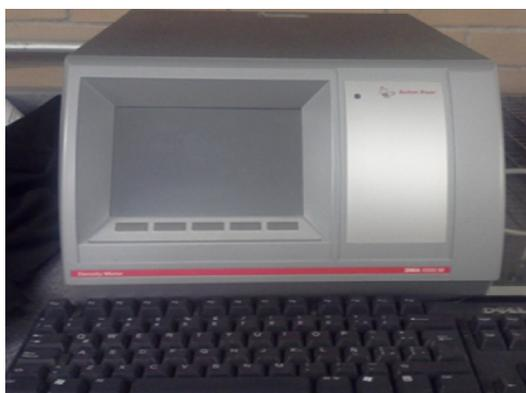
Figura 10.3: Densímetro marca Anton Paar modelo DMA 4500M.
