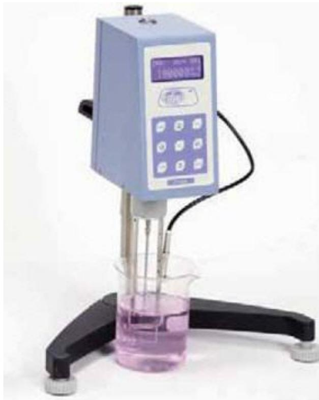
Figura 7.6: Ejemplo de viscosímetro rotacional[17].
