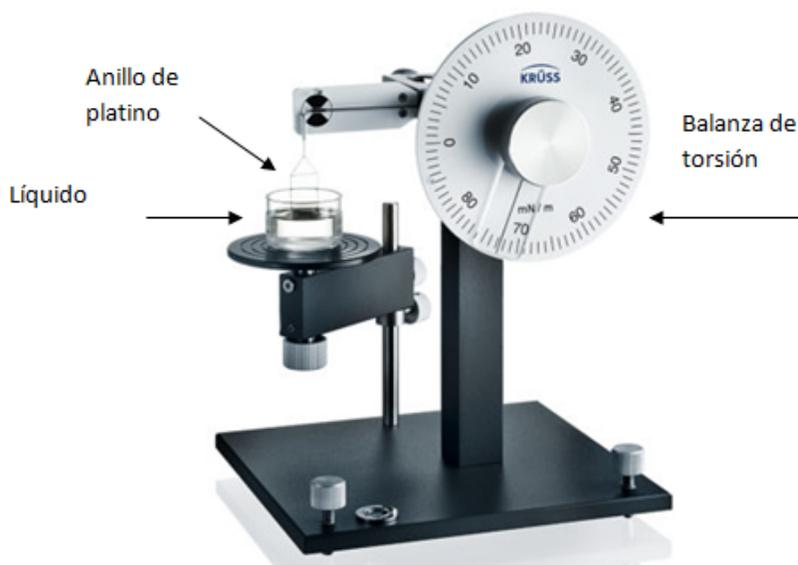
Figura 5.3: Equipo para medir tensión superficial mediante el método anillo de Du Nouy[9].
