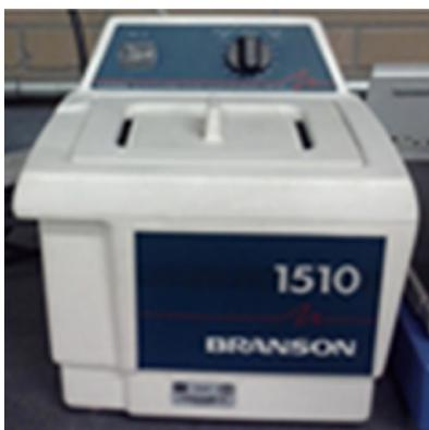
Figura 10.2: Equipo utilizado para sonicación.
