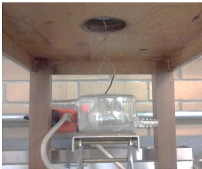
Figura 10.5: Equipo para medir tensión superficial e interfacial.
