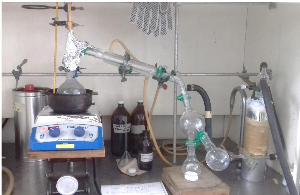
**Figura 21** Sistema de destilación a presión reducida de GMA.
