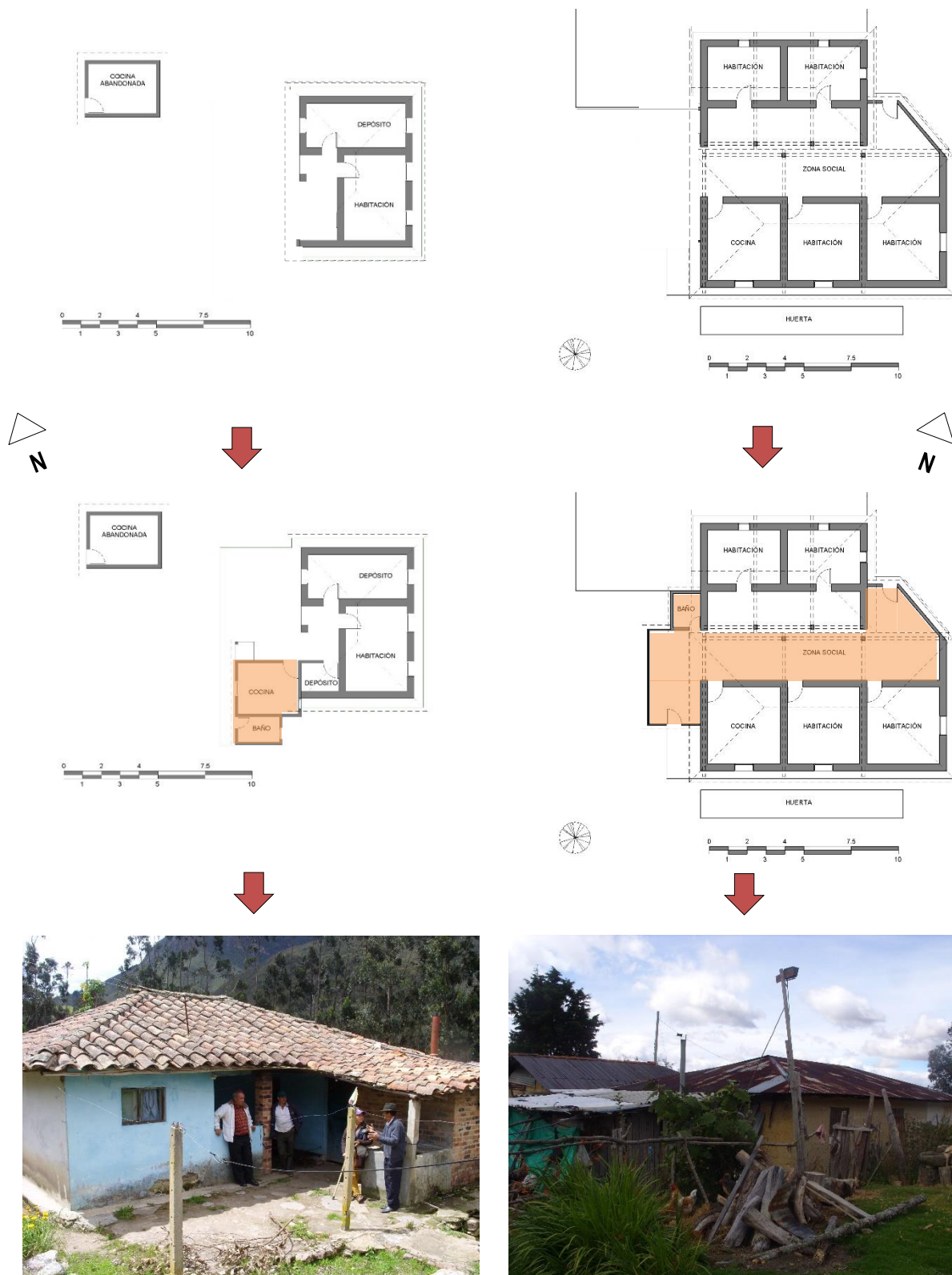
Ilustración 81. Hibridación por adición de volúmenes para un uso específico en el municipio de Arcabuco (izq.) y por conformación de un nuevo volumen a partir de dos existentes en Ráquira (der.)
