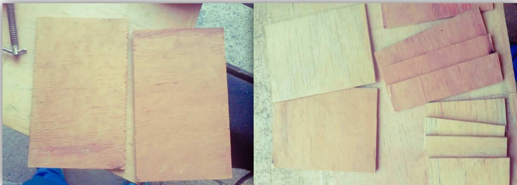
Fig.2.12 Cortes de las caras de triplay para formar las cajas amortiguadoras.
