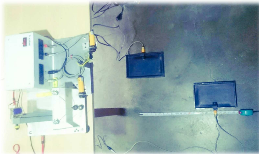
Fig.1.15 Colocación de las cajas amortiguadoras para anticipar de la caída de los balines.
