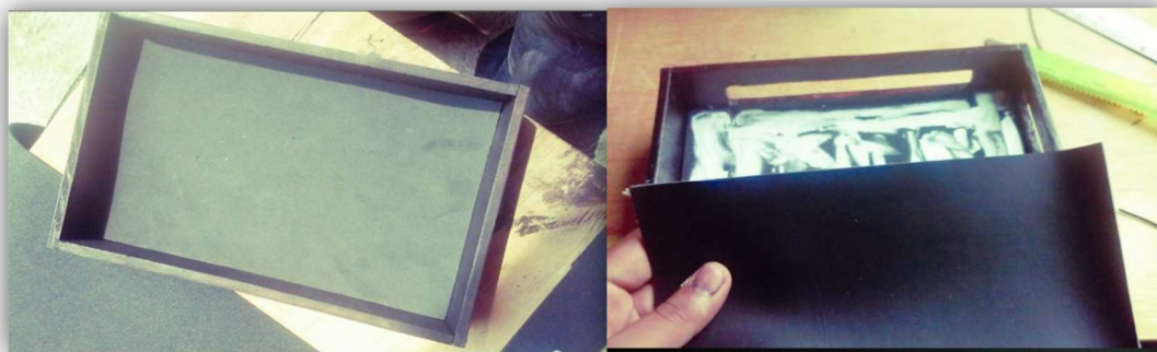
Fig.2.14 Goma eva utilizada para amortiguar la caída de los balines.
