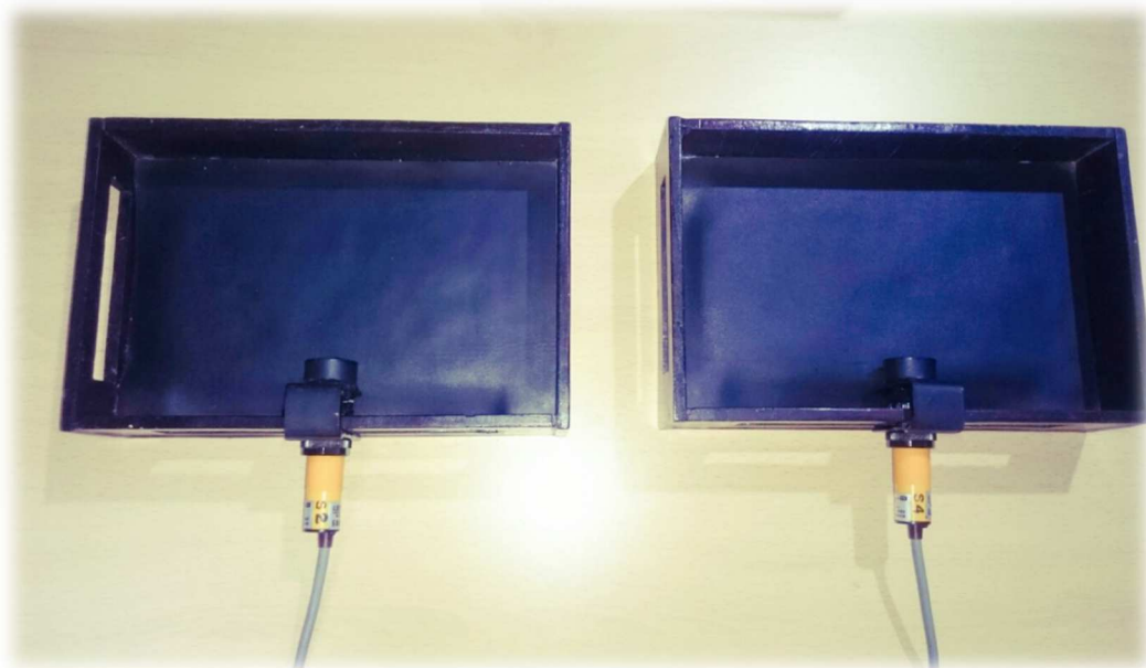
Fig.1.6 Colocación de los sensores de paro del cronómetro en sus respectivas cajas amortiguadoras.
