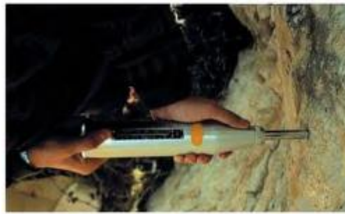
Utilización de esclerómetro (González de Vallejo, et al., 2002).
