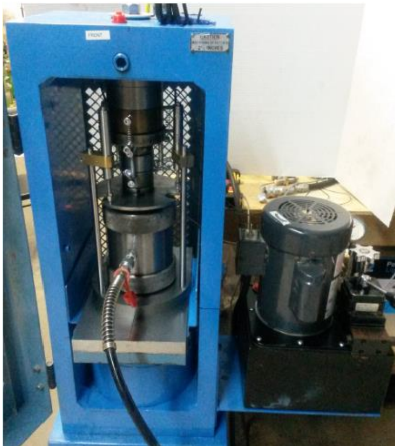
Figura 23.- Prensa utilizada en pruebas triaxiales.
