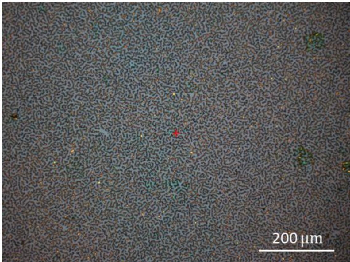
Figura 5-4. Detalle de la imagen (e) de la figura 5-3: 300 nm de Cu tras síntesis a 1,000 °C. El sustrato de silicio es notorio.
