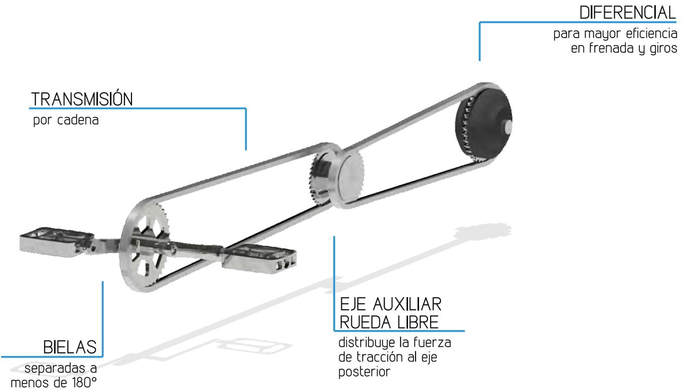
Figura 97. Mecanismo de tracción. 2014
