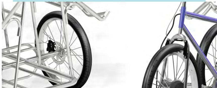
Figura 99. Frenos en llantas traseras y delantera. 2014
