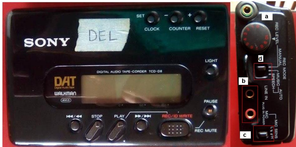
Figura 36. Grabadora SONY TCD-D8, a) perilla de la ganancia dada manualmente de 0 a 10, b) diferentes entradas para la grabadora (MIC y LINE IN), c) opciones con las que cuenta la entrada MIC (H y L) y d) modo de grabación (manual o automático).
