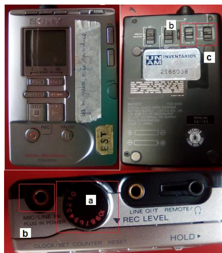
Figura 55. Grabadora SONY TCD-D100, a) perilla de la ganancia dada manualmente de 0 a 10, b) diferentes entradas para la grabadora (MIC y LINE IN) y c) opciones con las que cuenta la entrada MIC (0 dB y 20 dB).
