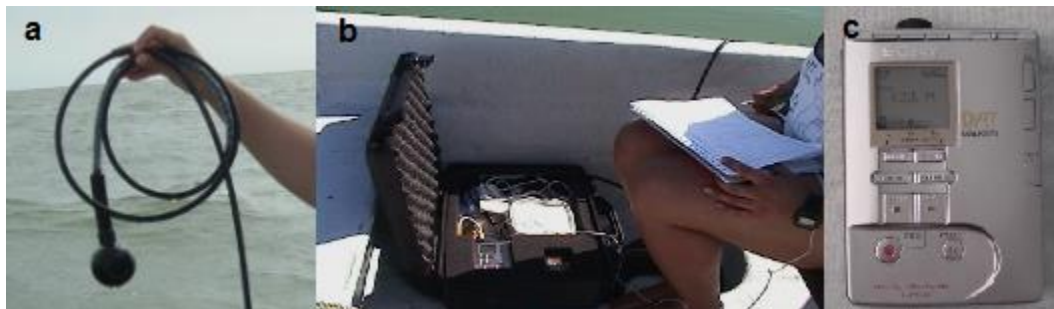
Figura 12. a) Hidrófono, b) sistema de grabación y c) grabadora utilizados en los muestreos.
