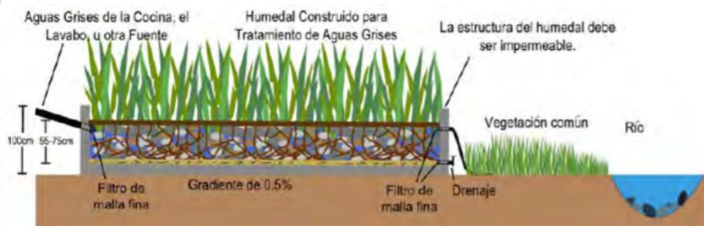
Figura 5.7 Sistema subterráneo de humedales construidos. Fuente: Sitio web <http://www2.bren.ucsb.edu/>
