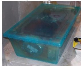
Fig. 7.22 Probetas siendo expuestas a dióxido de nitrógeno.
