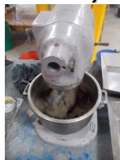
Fig. 7.11 Mezclado de cemento, arena y agua.
