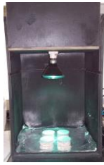
Fig. 7.18 Irradiación de luz UV-A a las probetas.
