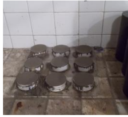
Fig. 7.15 Probetas en cuarto de curado.
