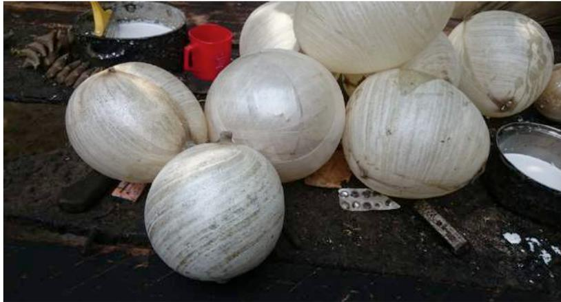
Imagen 66. "vejigas" infladas y listas para ser recubiertas con hule.
