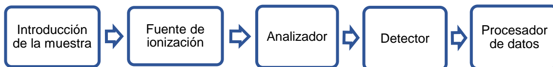
Figura. 2 Diagrama de la configuración del sistema para espectrometría de masas
