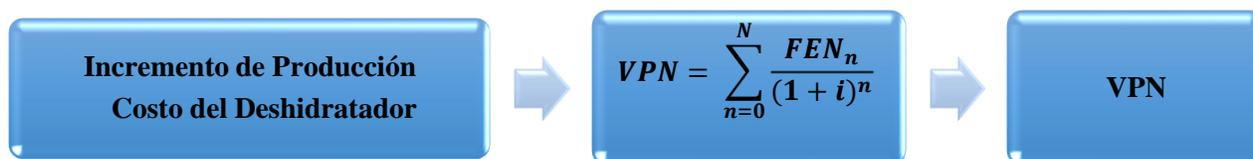
*Ilustración 45 Diagrama de caja negra modificando las variables de entrada; producción y costo del deshidratador*
