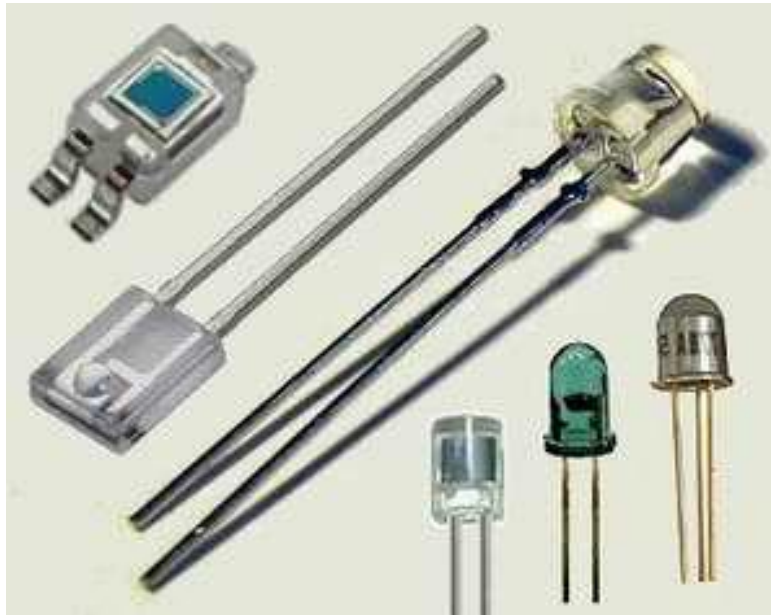
Figura 2.3.3. Diversos tipos de fototransistores
