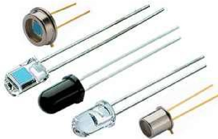
Figura 2.3.2 Diversos tipos de fotodiodo.
