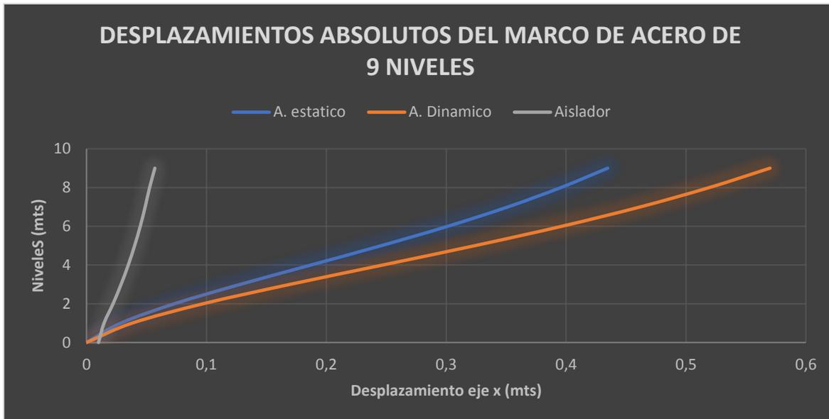
Por otro lado al obtener un desplazamiento corto en comparación con los otros dos análisis, el periodo con respecto a un sistema convencional es muy reflejante, podemos verlo en la tabla 1.6 con respecto el espectro de diseño, el sistema convencioanl y el aislador.
