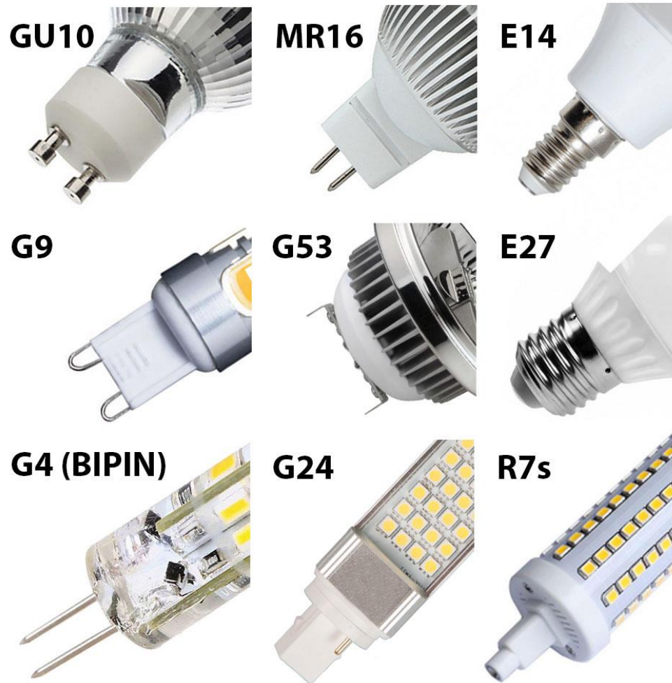
Figura 2. 21 Casquillos de las bombillas led
