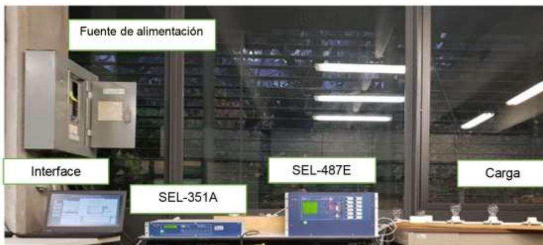
Figura 4.7 Instalaciones de la red de prueba en el laboratorio de Electrónica de Potencia
