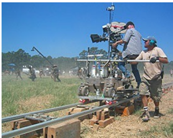
Figura 1.3: Sistema dolly usado en filmaciones profesionales.
